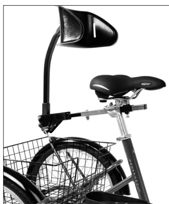
Gelsadel med ryggstöd monterad "framför" sadelrör.
