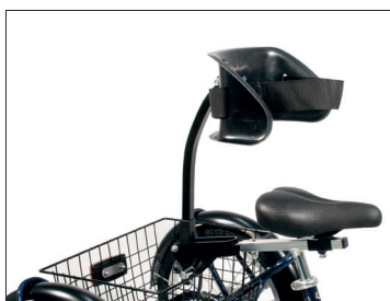
Standardsadel med ryggstöd monterad "framför" sadelrör.
