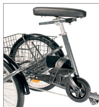
Limpsadel med T-stolpe monterad "framför" sadelrör.
