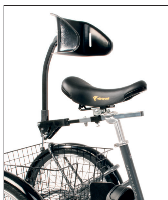
Banansadel med ryggstöd monterad "bakom" sadelrör.
